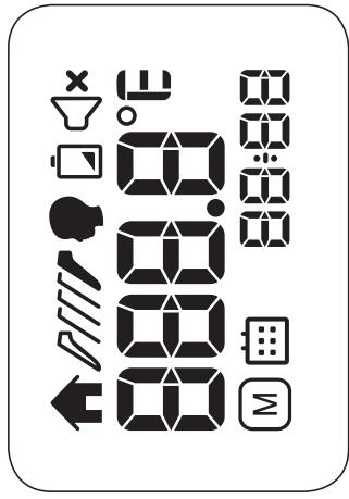
2. Der Standardmodus ist der Körpermodus. Drücken Sie die Modus-Taste ⑥ um in den Objektmodus zu wechseln. Um wieder zurück in den Körpermodus zu schalten, drücken Sie die Modus-Taste erneut.
